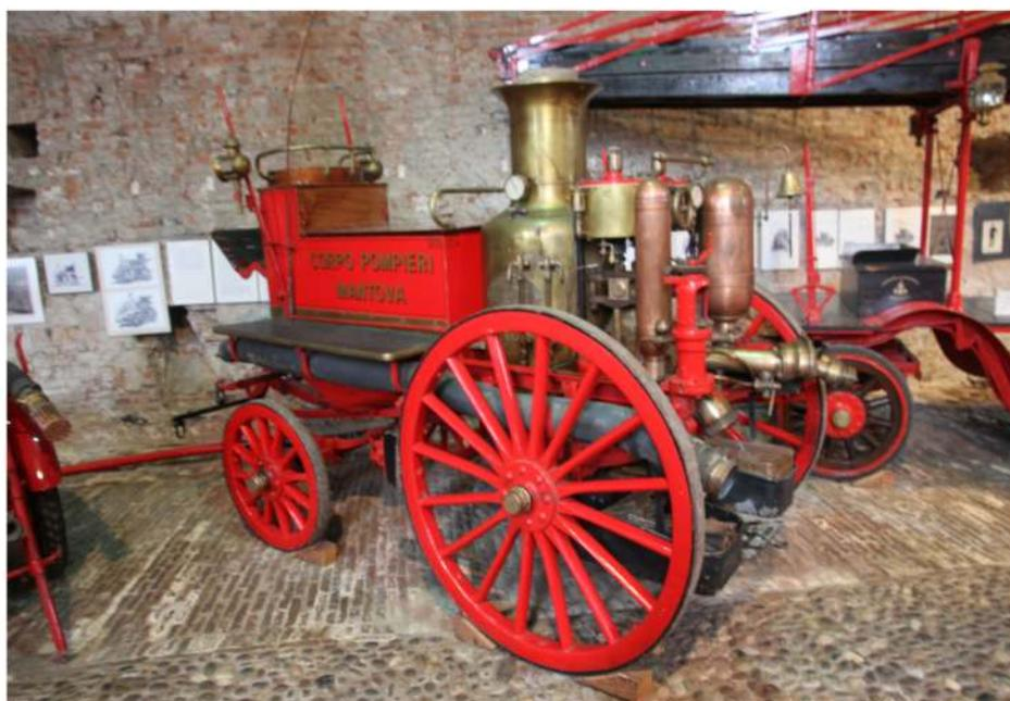
In alto: carro a vapore costruito dalla Merry Weather nella seconda metà dell'ottocento. Trainata da cavalli, per poterla utilizzare bisogna metterla in pressione; 4 cilindri, portata di 800 litri al minuto. Veicolo totalmente funzionante.
