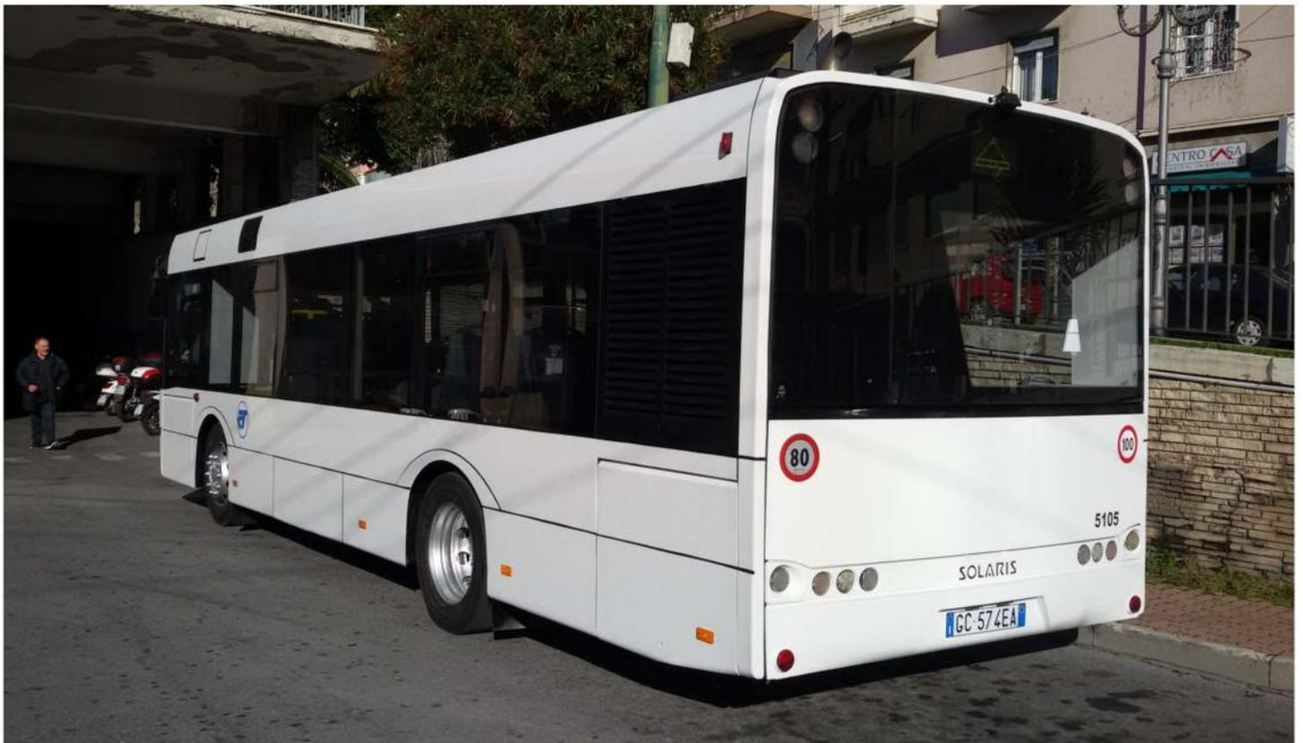
della lunghezza di 12 metri; dispone di due porte, di cui la centrale ad espulsione, con allestimento interurbano.
