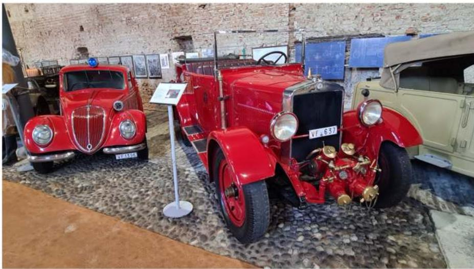
A lato: a sinistra la Fiat 1500 6C del 1936, 6 cilindri in linea, 46 CV a 4000 giri/min, 115 km/h, 6 uomini di equipaggio, veicolo dotato di serbatoio ad acqua e liquido schiumogeno mentre a destra la Fiat 614 L Autopompa del 1930, autopompa da incendio aperta, 4 cilindri, 1438 cc, 28 CV a 3400 giri/min, 60 km/h, 4 uomini di equipaggio.
