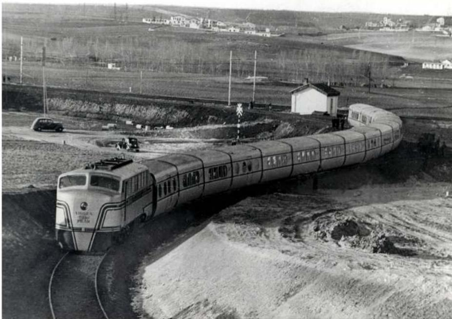
ferrovie degli Stati Uniti; sfortunatamente, questi progetti soffrivano di una scarsa comprensione delle dinamiche ferroviarie, della complessità delle sospensioni e dei principi dell'aerodinamica (per esempio il frontale dell'Aerotrain in realtà ha aumentato la resistenza all'aria mentre lo spoiler inferiore ha operato addirittura da aerofreno).
