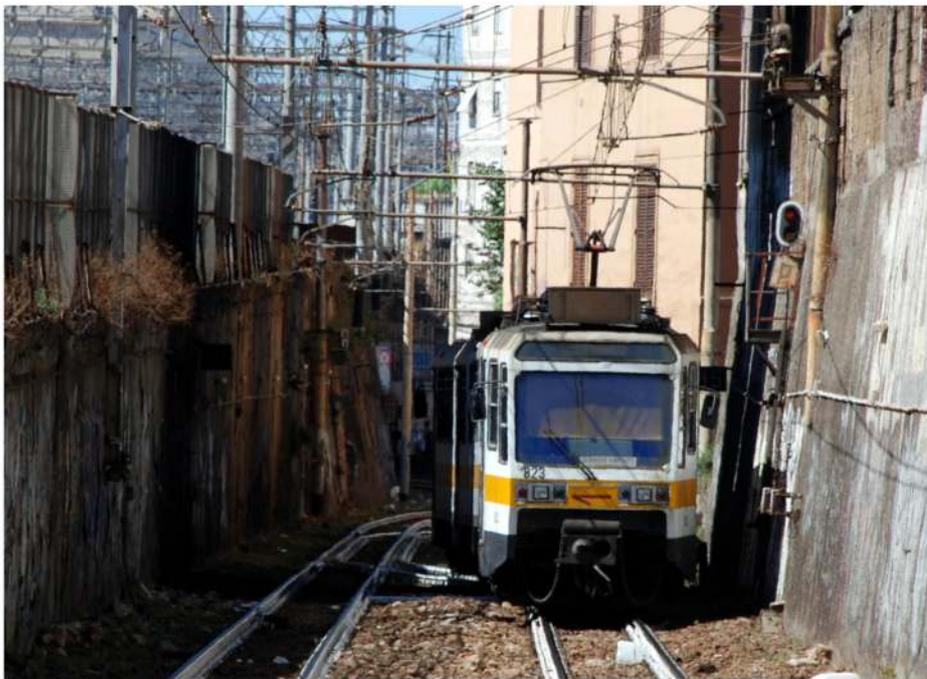
La circolazione dei treni è a destra, elettrificata in corrente continua con tensione da 1.650 V. e si sviluppa per 9 chilometri. Il servizio viene espletato dall'ATAC con corse cadenzate generalmente ogni 7 minuti dalle ore 6 alle ore 20, ogni 10 minuti nelle altre fasce orarie. Le corse vengono sospese dalle 22:30 alle 5:00. Il materiale rotabile deriva da quello originale della ferrovia Roma-Fiuggi-Alatri-Frosinone.
