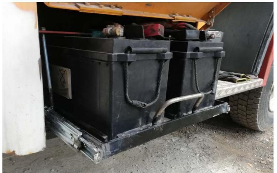
Nel 2021 avevamo, infatti, notato alcuni particolari da dover ripristinare, tra questi, in particolare, il vano batterie che si mostrava sensibilmente intaccato dalla ruggine ed i passaruota lato destro.
